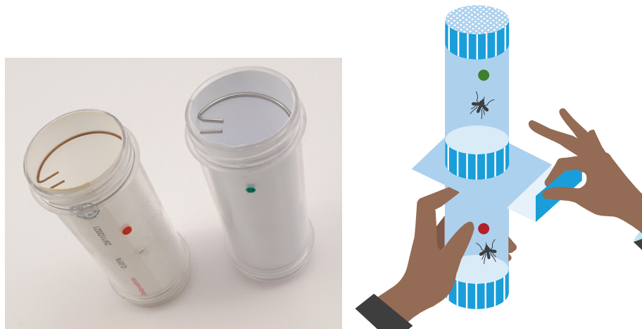
Figure 27: Présentation des tubes OMS (OMS 2022b) (A : Tube rouge, B : Tube vert, C : Tube rouge fixé au tube vert.)
