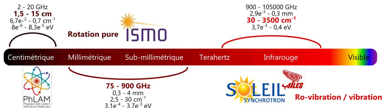
FIGURE 1.1 – Spectre électromagnétique de la lumière qui s'étend des longueurs d'onde centimétriques au domaine visible. Les gammes de longueurs d'onde couvertes par nos spectromètres ou via des collaborations sont indiquées (laboratoire de recherche ainsi que les gammes spectrales données en fréquences, longueurs d'onde, nombres d'onde et énergies).
