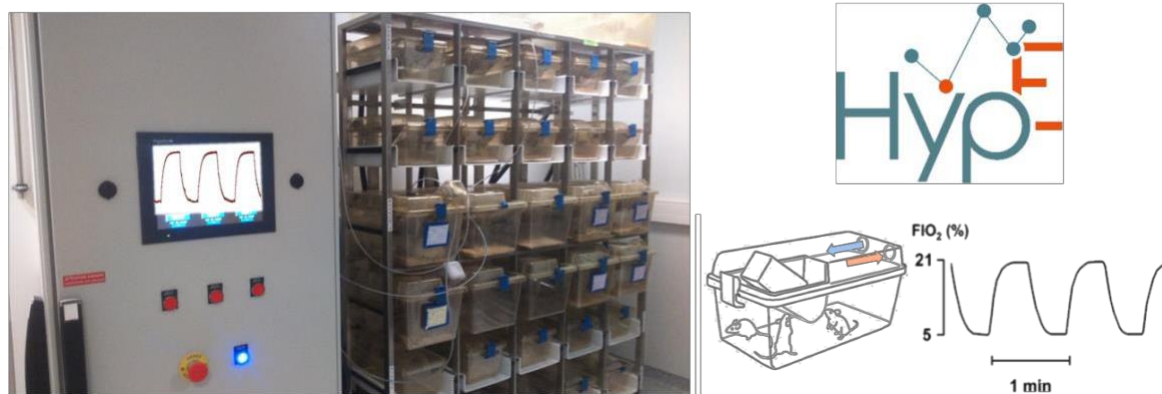
Figure 62 – Dispositif d'exposition à l'hypoxie intermittente
