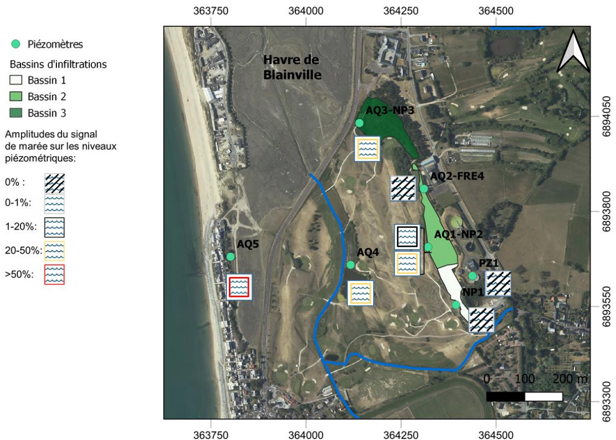
Figure II-24: Carte de l'amplitude de la fréquence de marée de 14.8 j dans les chroniques piézométriques de la nappe (sans tendances annuelles) par la méthode de Lomb-Scargle. Le piézomètre AQ1-NP2 possède deux période d'analyse : en été 2017 (haut) et en été 2018 (bas), le reste de l'année, aucune fréquence n'est identifiée sur ce piézomètre.
