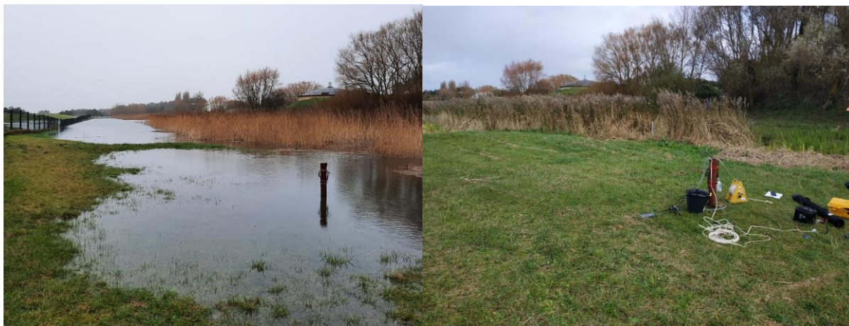
Figure II-15 : Photos du bassin d'infiltration n°1 (piézomètre NP1) en conditions de hautes eaux (février 2021) et basses eaux (octobre 2020).
