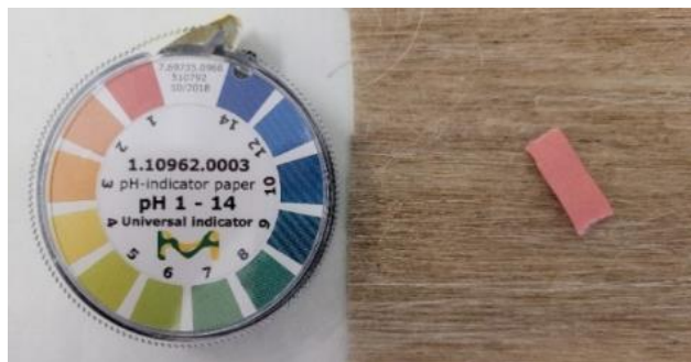
Figure III-3 : Photo d'un papier pH posé sur les fibres de lin en sortie du four de fluoration, la couleur démontrant un pH de 1 de par la désorption de HF
