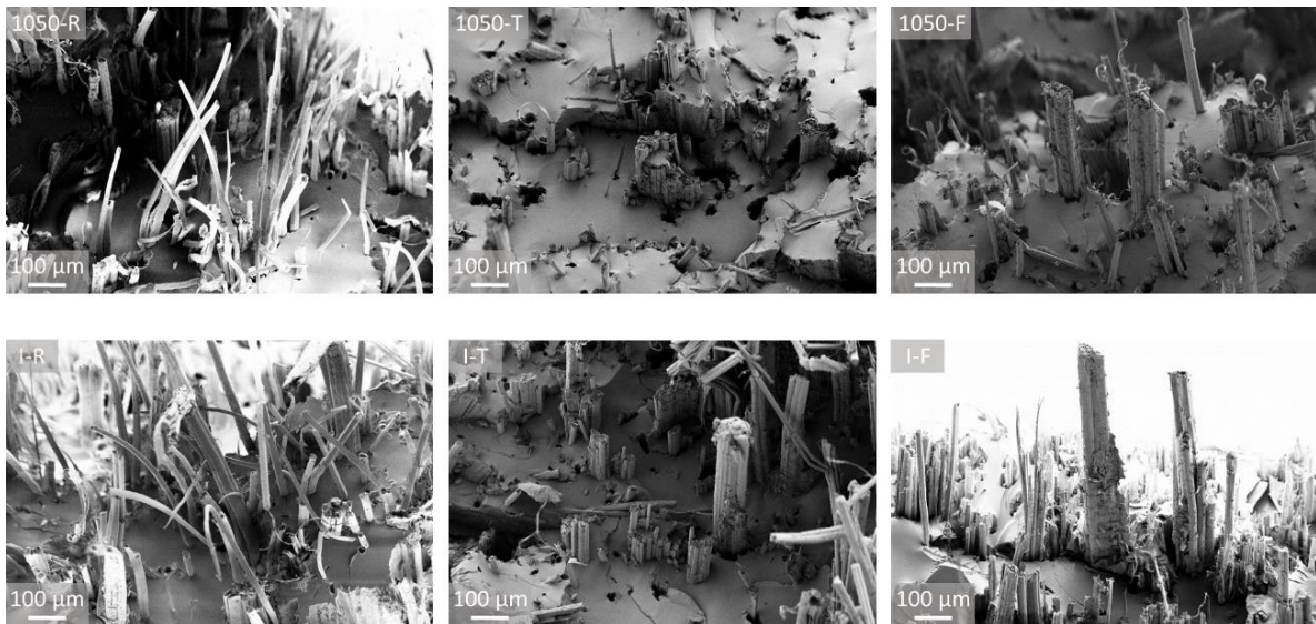
Figure IV-25 : Images MEB de la zone de rupture des échantillons testés en flexion
