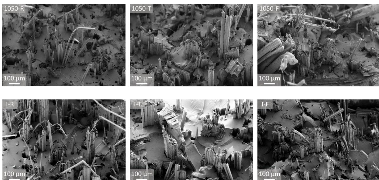
Figure IV-21 : Images MEB de la zone de rupture des échantillons testés en traction
