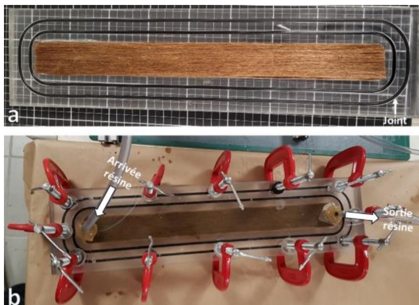
Figure IV-13 : (a) Placement des fibres au sein du moule ; (b) réalisation de l'infusion
