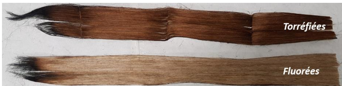
Figure III-28 : Photographie des fibres brutes fluorées et torréfiées avec post-traitement de fluoration
