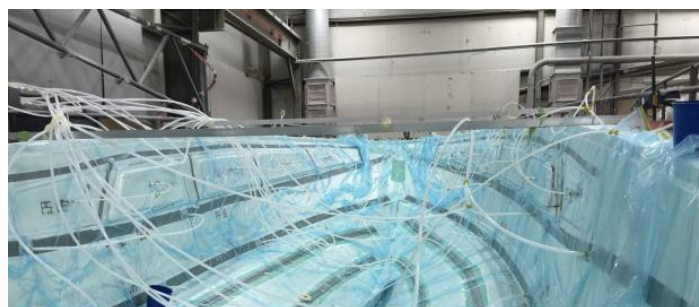
Figure I-21 : Yacht de croisière durant sa fabrication par infusion [36]
