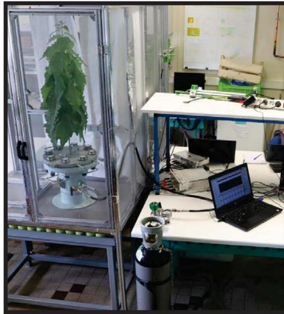
Figure 34 : Photo du dispositif de mise sous pression du système racinaire et de mesures électrophysiologiques.
