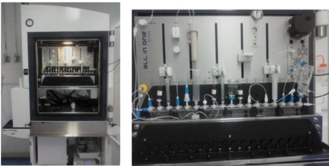
Figure 21 - Hotte blindée et module TRASIS
