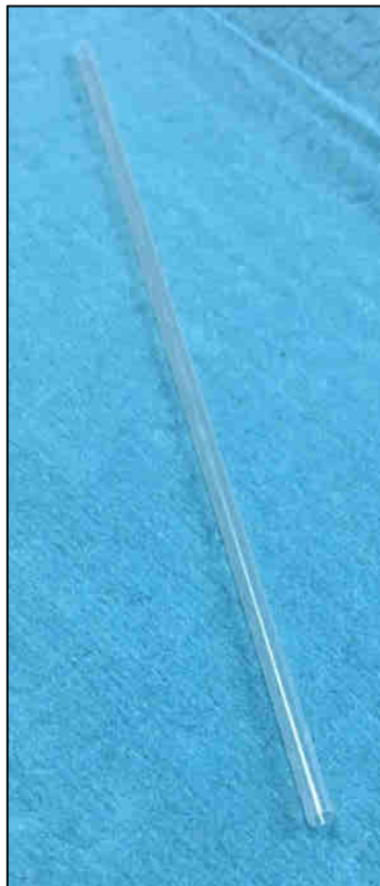
Figure Ann-6 : Prototype de RIBS réalisé par moulage par injection.
