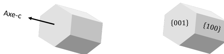
Figure 4.14. Illustration de l'axe de croissance des ZnO NBs ainsi que des faces cristallines exposées.
