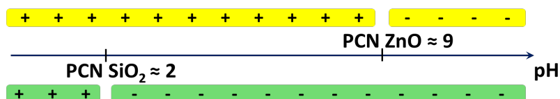
Figure 4.29. Diagramme illustrant les charges de surface de la silice et du ZnO en fonction du pH.
