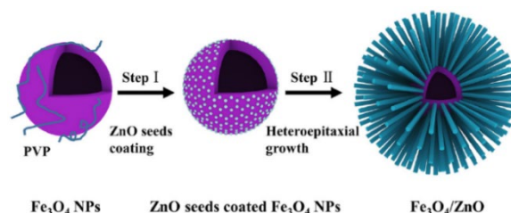
Figure 1.50. Représentation schématique de la formation de microcomposites Fe 3 O 4 @ZnO en forme d'oursin. 258
