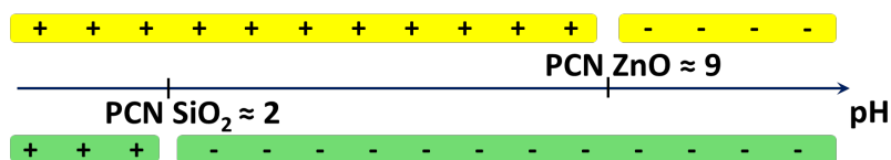
Figure 4.29. Diagramme illustrant les charges de surface de la silice et du ZnO en fonction du pH.
