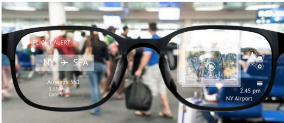
Figure 1. Vue artistique de lunettes intelligentes pour la réalité augmentée : l'information est affichée en surimpression sur un écran, qui permet aussi la vue de la scène réelle.
