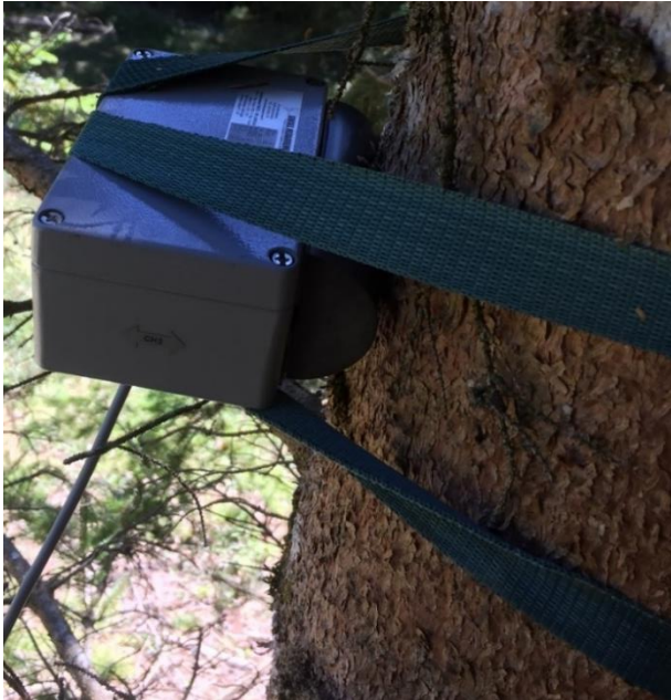
Figure 3-1 Dispositif de fixation des capteurs sur les arbres
