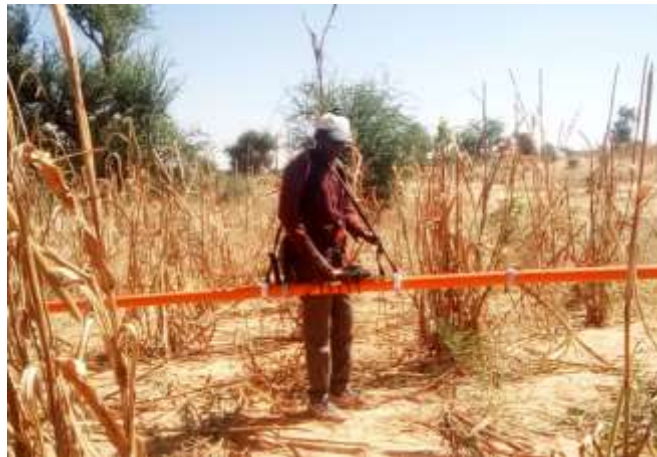
Planche photo 11: Equipement CMD-Explorer pour la cartographie électromagnétique sur le bassin de Ouama (Coordonnées en UTM : 31P ; X : 310548 ; Y : 1541390 ; 13/11/2018)
