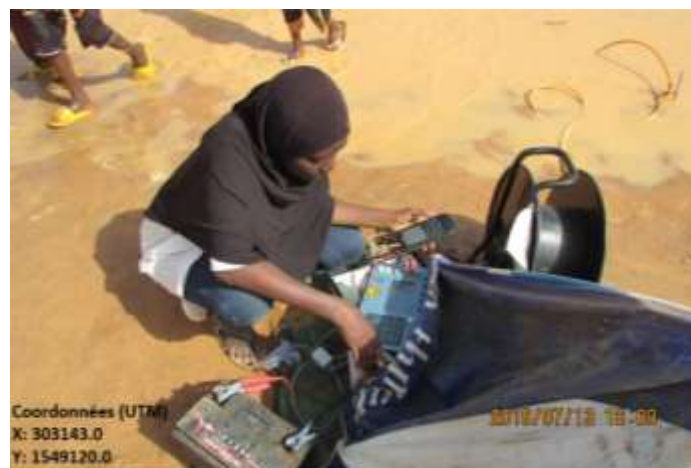
Planche photo 9: Equipement Syscal Pro Switch pour la réalisation de tomographie électrique sur le bassin de Ouama
