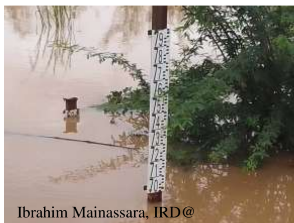
Planche photo 3: Nouvel élément de l'échelle à la station de Niamey deux jours après son installation (le 09/09/2020 à 13h13) sur le fleuve Niger
