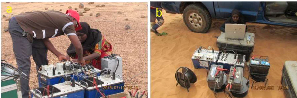
Planche photo 12: Deux appareils de sondage RMP utilisés sur le terrain. a- Equipement Numis plus pour le sondage RMP sur le plateau de Gonga Zougou (Coordonnées en UTM : 31P ; X : 433424 ; Y : 1460694) ; b- Equipement Numis Auto pour le sondage RMP sur le site de Gorou Tchirey (Coordonnées en UTM : 31 P ; X : 407705 ; Y : 1484525)
