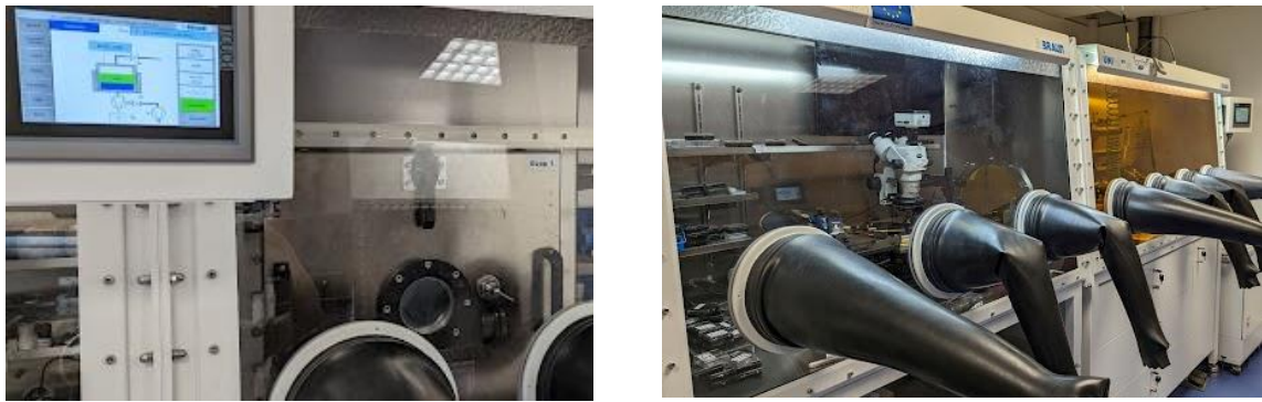
Figure 33 : Evaporateur par effet Joule et équipement de caractérisation électrique intégrés en boîte à gants.
