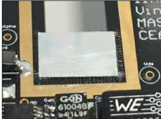
Figure 3-22 : Connexion entre le résonateur LNO et la carte électronique par « wire bonding »
