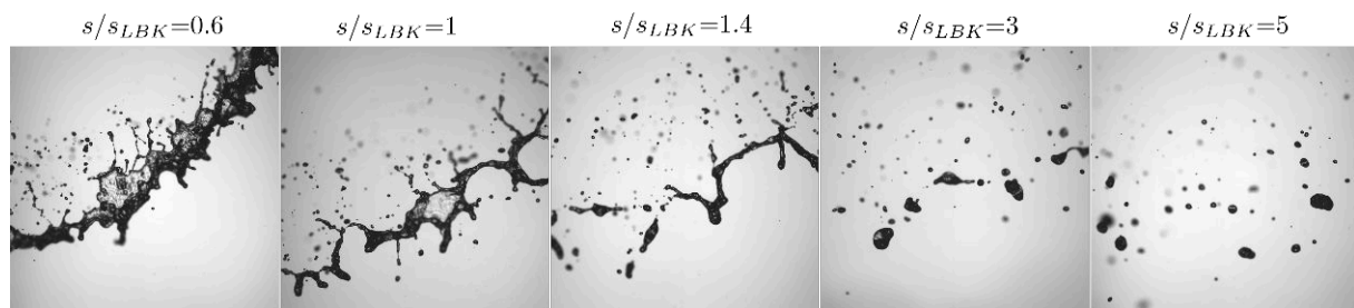
FIGURE 4.42. – Images par ombroscopie des positions sur les Figures 4.40 et 4.41.
