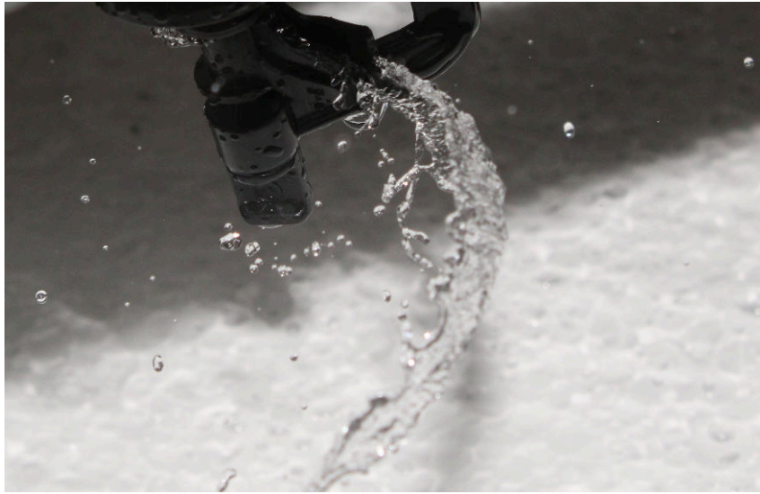
FIGURE 1.5. – Photo d'un micro-asperseur rotatif, Rolland Rotojet 3C pendulaire. La courbure du jet est dépendante de la vitesse de rotation du rotor. Dans le cas présent, le sens de rotation est anti-horaire.
