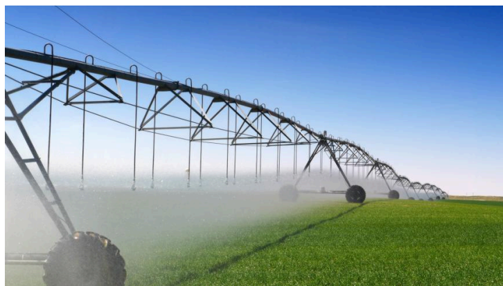
FIGURE 1.1. – Utilisation d'un système de pivot pour l'irrigation avec des micro-asperseurs rotatifs pendulaires.
