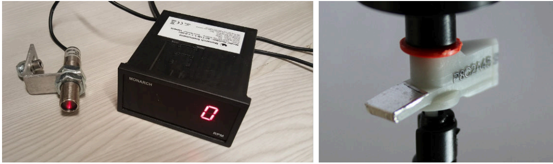
FIGURE 2.9. – Capteur optique et réflecteur placé sur le micro-asperseur.
