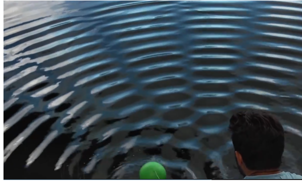
FIGURE 4.1 – Sur cette photo d'expérience réalisée en milieu naturel, on observe l'opérateur générant en deux points sources distants, des ondes mécaniques à la surface de l'eau, i.e. des vagues. De ces deux points sources, des vagues se propagent de manière concentrique et l'on observe bien les nœuds et les ventres de l'interaction entre ces deux ondes : une Figure d'interférence.
