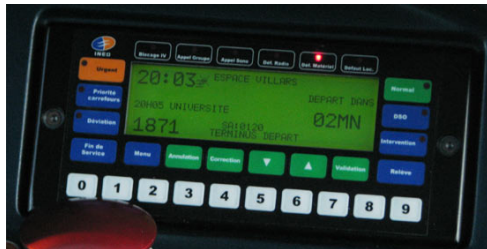
FIGURE 1.5 – Un pupitre SAEIV Ineo dans un tramway
