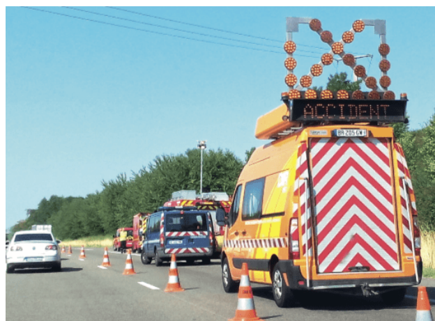
FIGURE 1.10 – Une camionnette de la sécurité routière avec un panneau à messages variables
