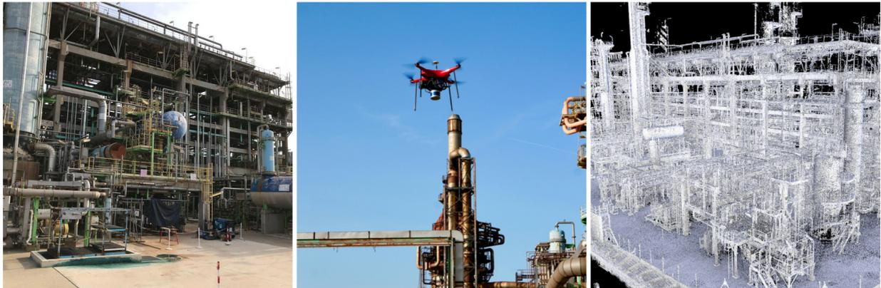
FIGURE 0.1 – Campagne réalisée avec Gambi-M. Essai de vol télépiloté dans une infrastructure industrielle extrêmement complexe. Relevé topographique avec le dispositif Faro Focus X130.
