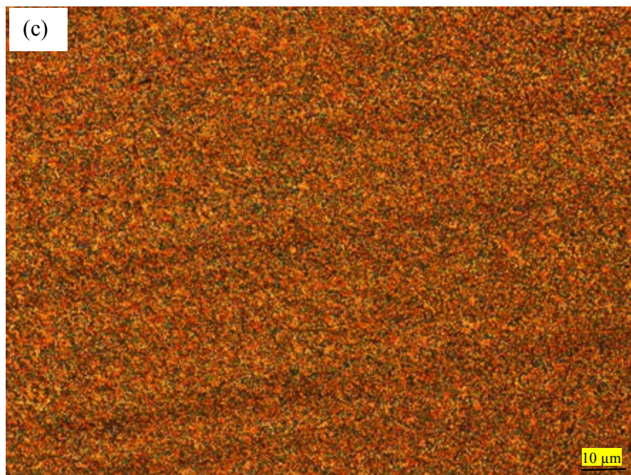
Figure 87 : Photos MOP des films PDLC élaborés avec CL3 : a) 9 \mu\text{m} , b) 15 \mu\text{m} et c) 20 \mu\text{m} .
