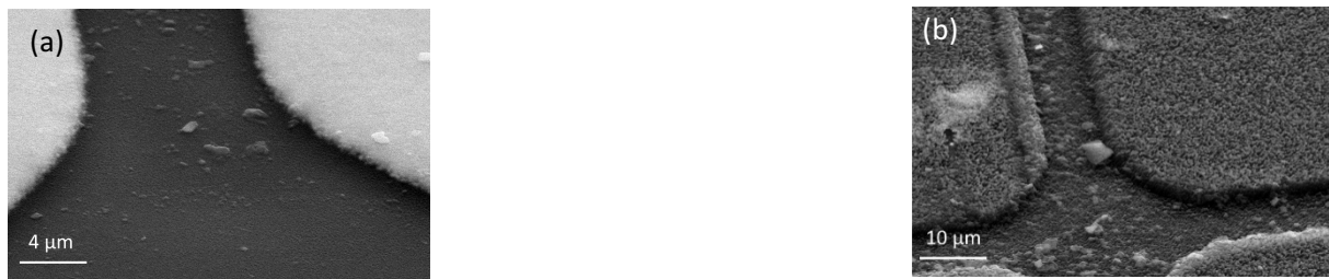
Figure 3 : Images MEB de la plaque du verre TFT : (a) avant, (b) après le cratère ToF-SIMS.
