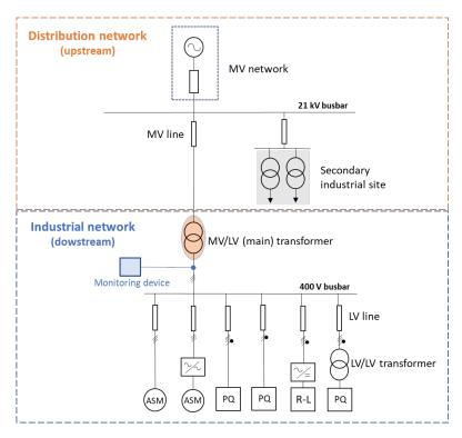
Figure 1: Schéma simplifié d'un réseau électrique industriel en BT.
