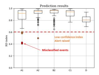
Figure 4: Analyse d'erreurs de classification en utilisant l'indice RD, où 5 événements déclenchent une alerte en raison d'un faible indice de confiance, et dont deux correspondent à des erreurs de classification.
