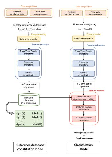
Figure 2: Schéma global de l'algorithme avec deux modes de fonctionnement: constitution de la base de données et classification d'un nouveau creux de tension.
