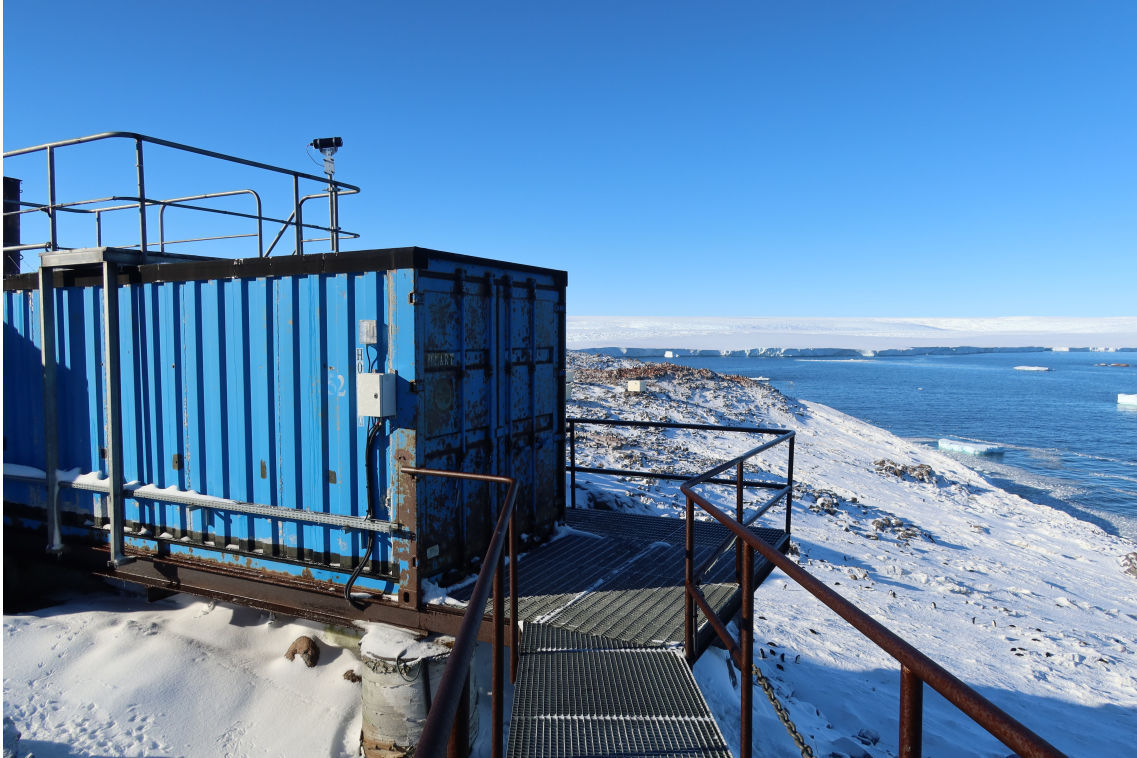
FIGURE 2.2 – Photographie de l'abri contenant le lidar à DDU, prise lors de la campagne réalisée en 2022. Sur le toit sont situés les hublots de sortie laser et de réception pour le télescope. La photo est prise depuis DDU et donc de l'île de Péterels, en arrière plan il s'agit du continent Antarctique.
