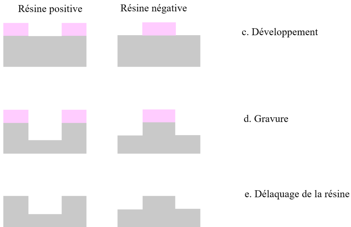
Figure 103, Schémas des étapes de gravure après photolithographie
