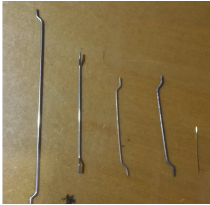
(a) Fibres de chez Bekaert, de gauche à droite : 3D 80/60, 3D 65/35, 3D 80/30, 3D 45/30, OL 13/.20
