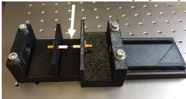
Figure 34 : Porte échantillon pour les mesures en transmission. La flèche indique l'emplacement de l'échantillon (F. Decroos).
