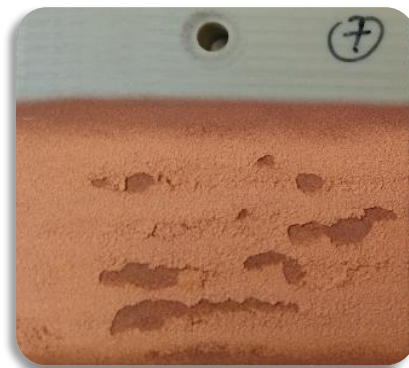
Figure 5 : Délamination précoce d'un revêtement projeté de cuivre - L. Lalu Koithara, F. Decroos
