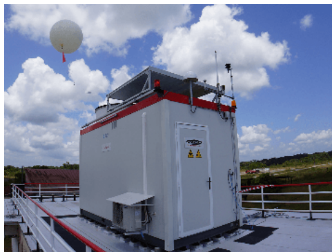
FIGURE 1.5 – Exemple de ballon-sonde, lancé automatiquement par Météo-France. Les différents instruments mesurant les composantes de l'atmosphère sont situés dans la nacelle à l'extrémité inférieure du dispositif.
