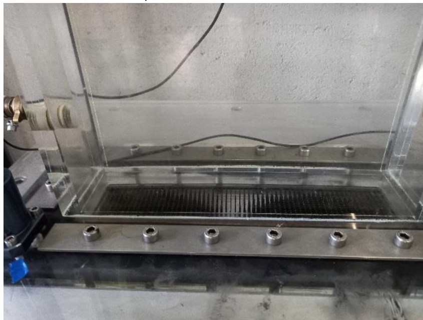
Figure 2-3 : Photo du diffuseur capillaire mis en place dans la colonne
