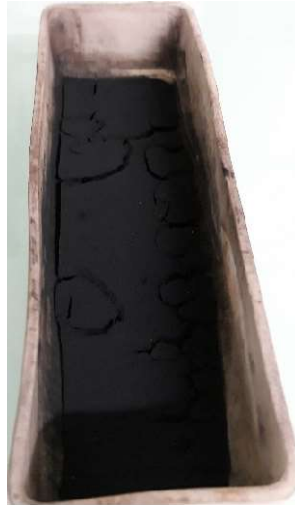
Figure 2-13 : Photographie de la poudre de NMC333 obtenue après le traitement thermique à 900°C pendant 12h.
