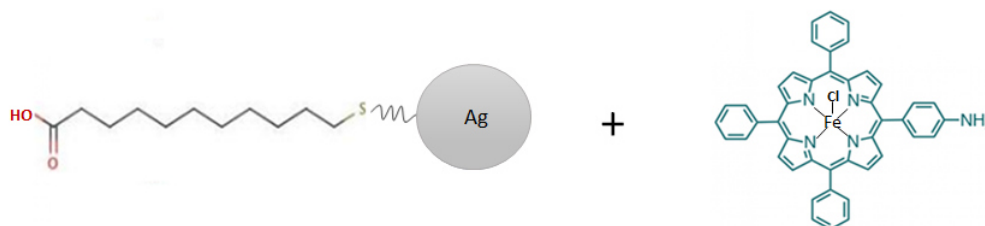
FIGURE 4.27 – Principe de la voie 2 de greffage : venir greffer les thiols sur les nanoparticules avant de faire la liaison amide entre le MUA et le colorant.
