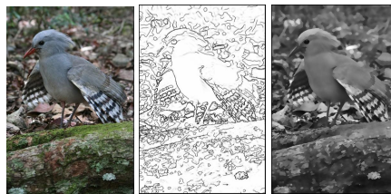
FIGURE 1.9 – Segmentation d’une image en utilisant un algorithme basé sur la fonctionnelle de Mumford-Shah (image extraite de [225]).
