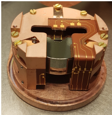
Figure II.15 – Gauche : Photographie du détecteur RED106 (sans électrodes, mesurant uniquement le signal chaleur) installé dans un nouveau support. Droite : Spectres de bruit du détecteur RED106 placé sur la chambre de mélange (mesure non suspendue) et pulse tube ON. En orange dans l'ancien support, en violet dans le nouveau support. Figure extraite de [63].
