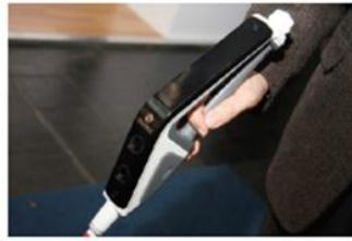
Figure 1.16 : Dispositifs à ultrasons solidaires de la canne blanche
