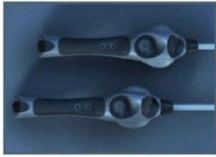
Figure 1.16 : Dispositifs à ultrasons solidaires de la canne blanche
