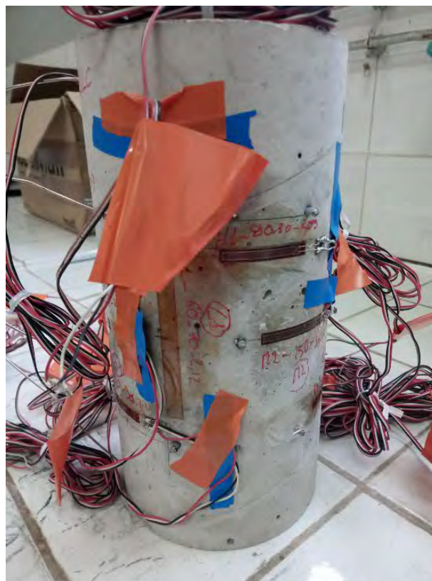
FIGURE A.1 – Photographie de l'éprouvette instrumentée avec le capteur orthoradial à fibre optique et les jauges résistives
