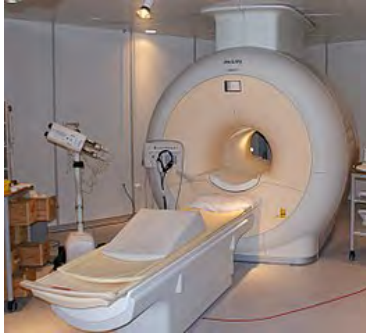
(a) Un scanner IRM conventionnel d'une puissance de 1.5T (Philips scanner). Credit: Jan Ainali, (CC BY 3.0), https://commons.wikimedia.org/wiki/File:MRI-Philips.JPG
