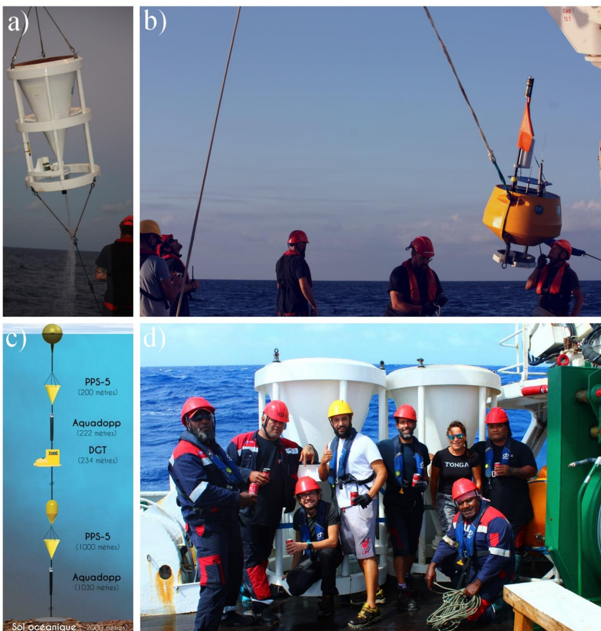
Figure II-21. Photographies (a) du piège à sédiments PPS-5, (b) de la récupération de la ligne de mouillage dérivante et (d) de la super team de la petite campagne “TONGA-RECUP” après la récupération de la ligne fixe laissée durant une année entière dans le Bassin de Lau. En (c) est schématisée une part de l’instrumentation déployée sur la ligne de mouillage fixe. Crédit photo : Cécile Guieu pour la photographie (d).
