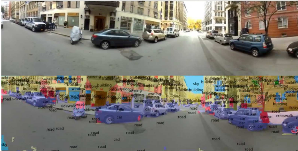
FIGURE 2.6 – Classification des éléments d’une image lors d’une prise de vue en temps réel par un réseau de neurones convolutionnel entraîné sur le jeu de données SiftFlow. Image extraite de Farabet et al. (2013).
