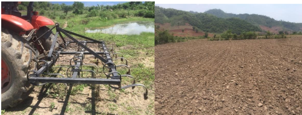
Figure 20 : Cultivateur à dents testé pour améliorer les états de surface
