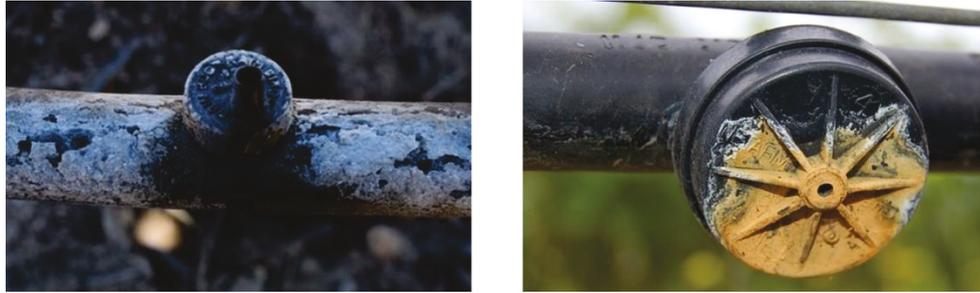
**Figure 15 Précipitation chimique en sortie de conduite<sup>6</sup>**
