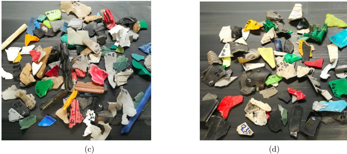
FIG. 1.10 Photos de fragments de plastiques ABS 1.10a, HIPS 1.10b, PE 1.10c, PP 1.10d.
