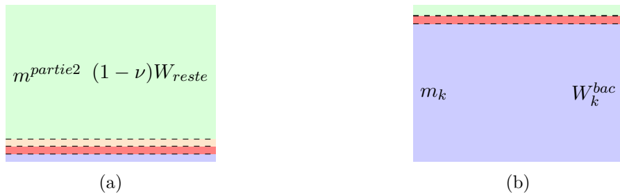
FIG. 5.8 Estimation de la composition finale du bac d'après notre hypothèse simple, au début du remplissage ( k petit), 5.8a et sur la fin du remplissage ( k grand), 5.8b avec \nu = 0.05 .
