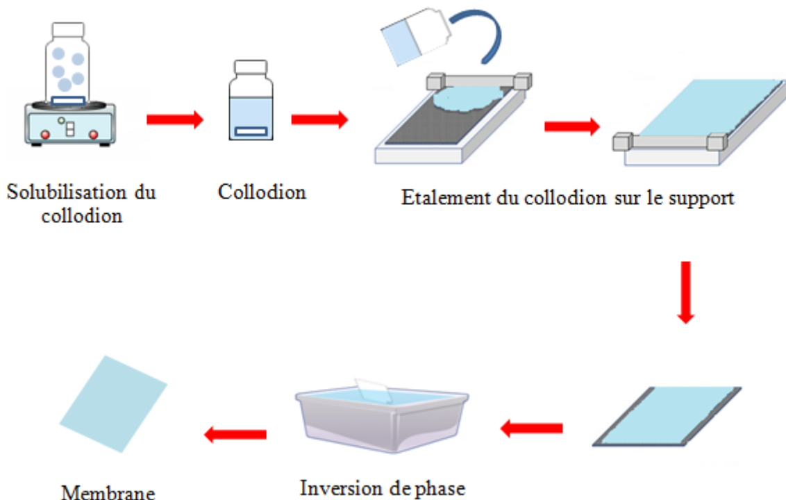
Figure I-9 : Synthèse d'une membrane par inversion de phase par immersion.
