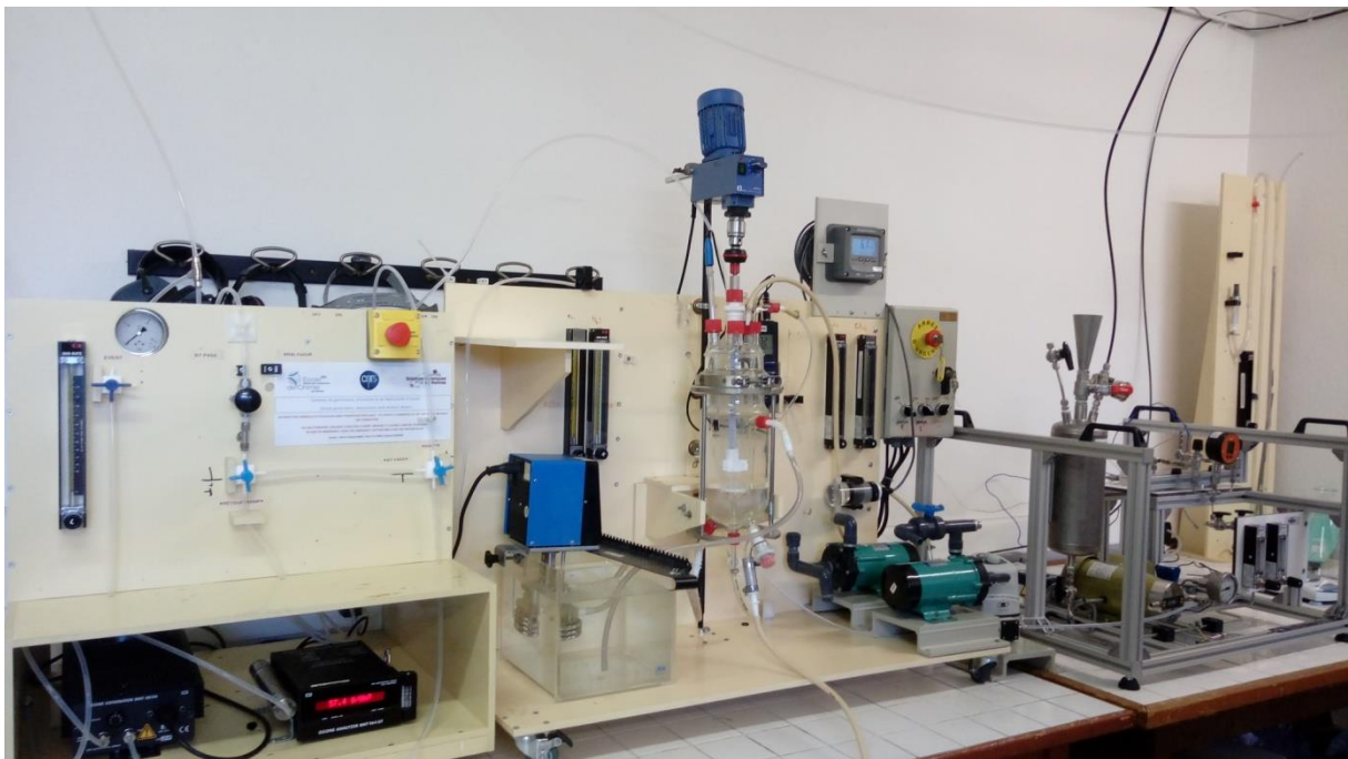
Figure II-5 : photographie du pilote couplant la nanofiltration et l'ozonation.
