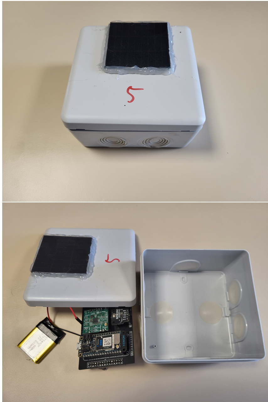
FIGURE 4.5 – Nœud capteur du réseau expérimental proposé
