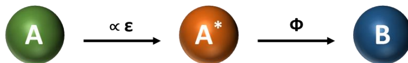
Figure 154 : Processus de formation A \rightarrow B . Lorsque A absorbe un photon il se convertit en A^* proportionnellement à \epsilon . A^* peut ensuite évoluer vers B avec une probabilité \Phi .
