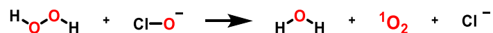
Figure 57 : Décomposition du peroxyde d'hydrogène en présence d'ions hypochlorite pour former une molécule de dioxygène singulet.
