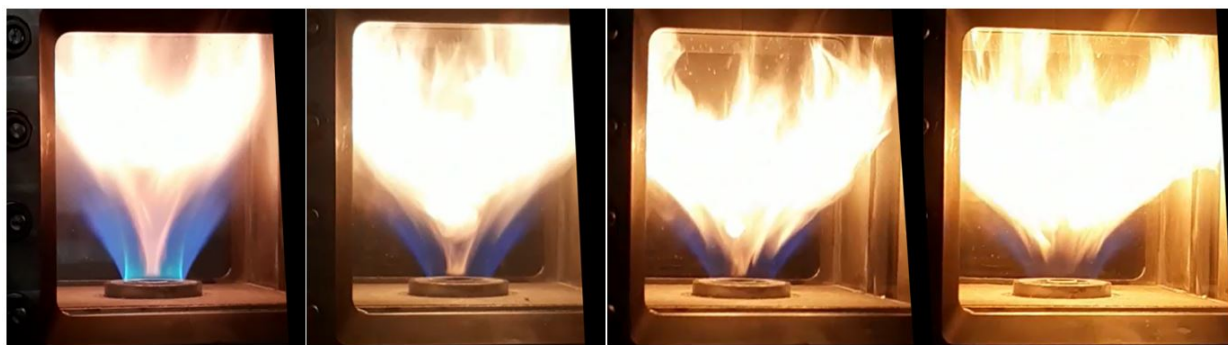
FIGURE 6.1 – Emission naturelle de la flamme SIRIUS observée à 1, 2, 3 et 4 bar (de gauche à droite, même temps d'exposition caméra)
