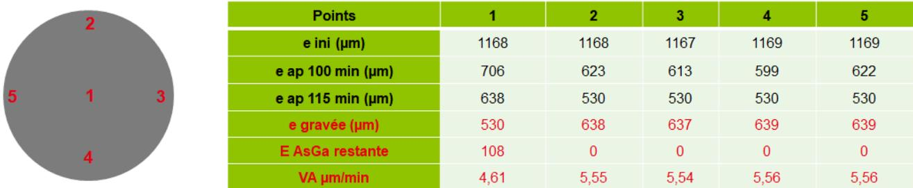
Figure 6.48: Mesures d'épaisseur en différents points de la plaque après chaque gravure avec SC1.
