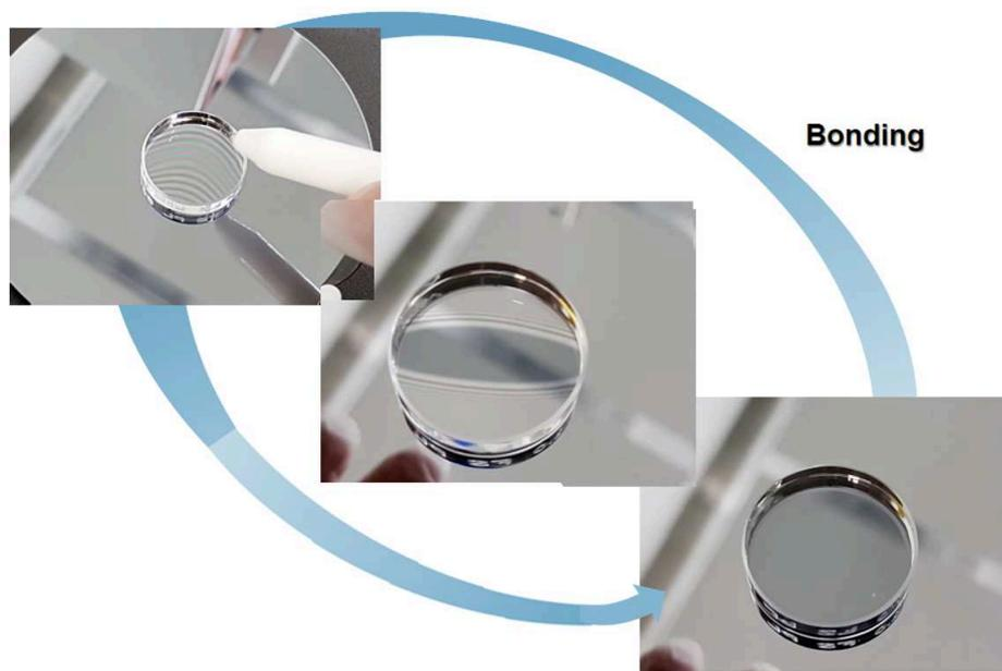
**Figure 6.5:** Exemple du déroulement du collage direct d'un substrat épais de silice sur un substrat de silicium.
