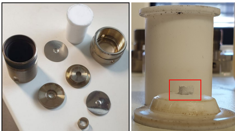
Figure D2 : (gauche) Image d'un autoclave démonté utilisé pour les synthèses solvothermales. L'autoclave de Parr Instrument, modèle 4749, a un volume de 23mL (droite) Exemple de monolithe typiquement obtenu en fin de traitement.
