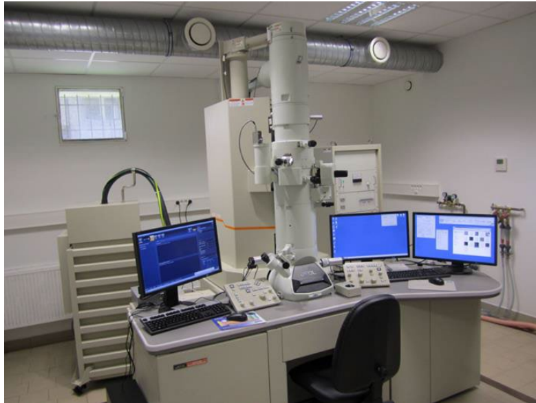
Figure G7 : Microscope électronique en transmission JEOL 2100 HT, laboratoire INL, Université Claude Bernard Lyon 1
