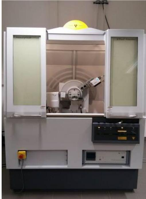
**Figure G2 : Photo du diffractomètre X'Pert 3 de Malvern Panalytical**
