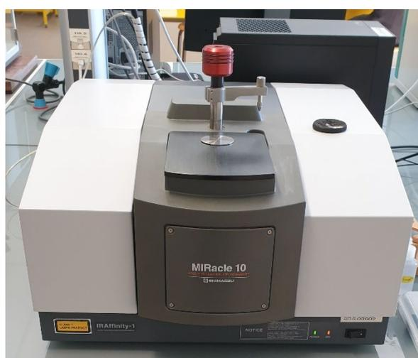
**Figure G11 : Spectromètre FT-IR IRAffinity-1 avec cellule ATR MIRacle 10 de Shimadzu**
