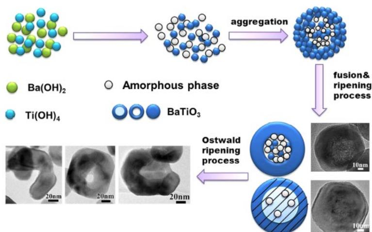
**Figure B17 :** Représentation schématique du processus de mûrissement d'Ostwald pour la formation de sphères creuses de  $BaTiO_3$  à partir de précurseurs hydroxylés de  $Ba(OH)_2$  et de  $Ti(OH)_4$  [170].
