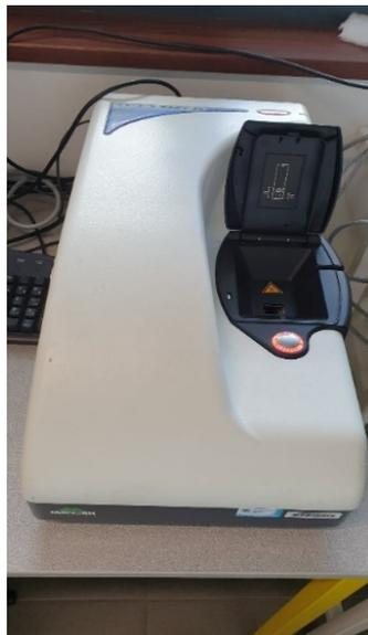
**Figure G9 : Appareil DLS Zetasizer Nano ZS de Malvern**
