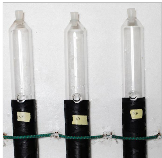
Figure 4.5 - Dispositifs de mesure de la phototaxie
