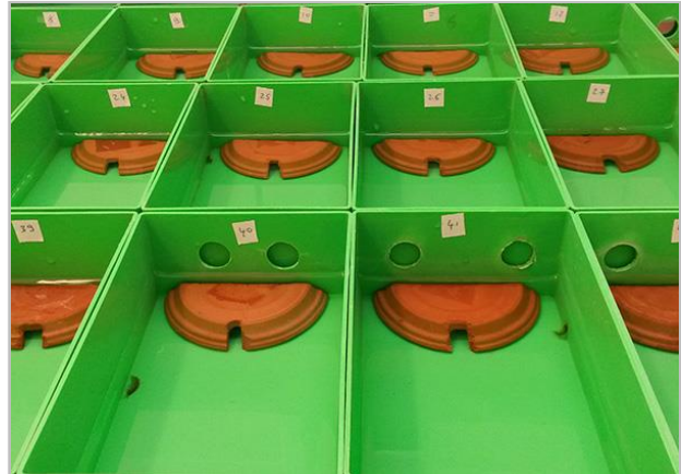
Figure 4.4 - Dispositifs de mesure de l'entrée sous refuge
