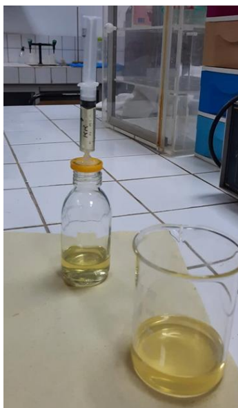
Figure 4.1 : Sol de BCZT préparé par la méthode sol-gel.
