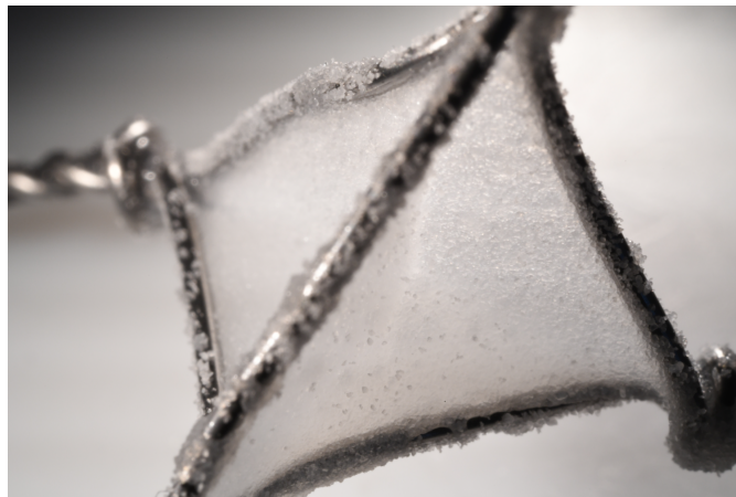
FIGURE 2.17 – Film liquide composé d'un mélange eau/glycérol, couvert de microparticules et suspendu à une cadre pyramidale de largeur 1 cm.
